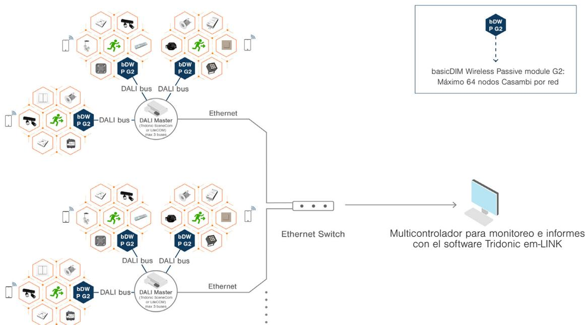
Tridonic proporciona iluminación de emergencia inalámbrica basada en la tecnología Casambi. Esta solución aporta fuerza adicional a la malla inalámbrica y al sistema en general, además de admitir dispositivos estándar DALI DT1, lo que significa una interoperabilidad segura con el equipo de control de emergencia de batería local DALI. La interoperabilidad de DT1 proporciona capacidades avanzadas de extracción de datos de los dispositivos para cualquier otro análisis que pueda ser necesario.
