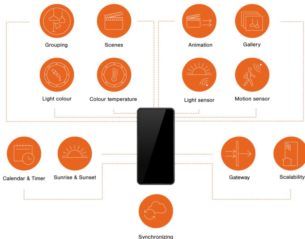
**Grupos:** Agrupamiento es un método de organización de las luminarias. Esto puede facilitar la búsqueda posterior de las luminarias correctas (especialmente en una red grande). Una luminaria solo puede formar parte de un grupo. Todas las luminarias agrupadas se pueden controlar conjuntamente y/o programar para control individual.
